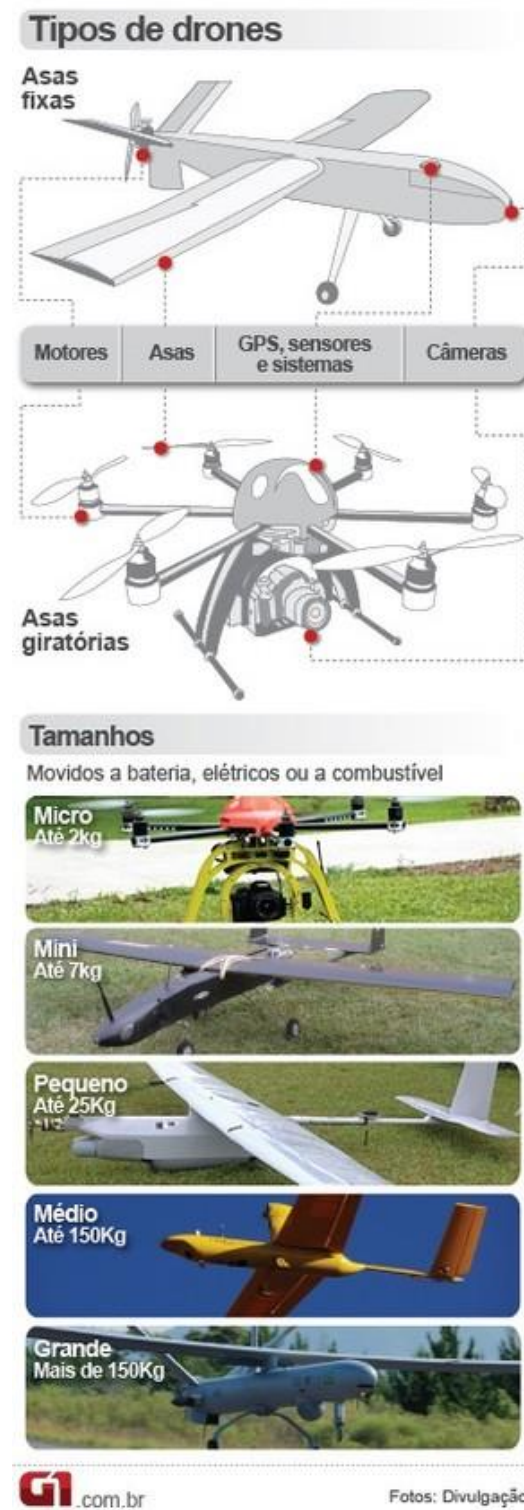
Figura 3: Representação gráfica das medições previstas para caracterização de alguns dos tipos de VANT's já existentes.
